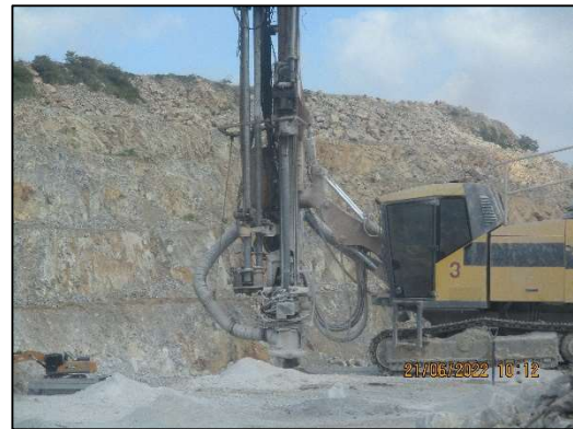
ภาพที่ 2-12 เครื่องเจาะรูระเบิดที่ติดตั้งเครื่องดักจับฝุ่นแบบถุงกรอง (Dust Collector)
