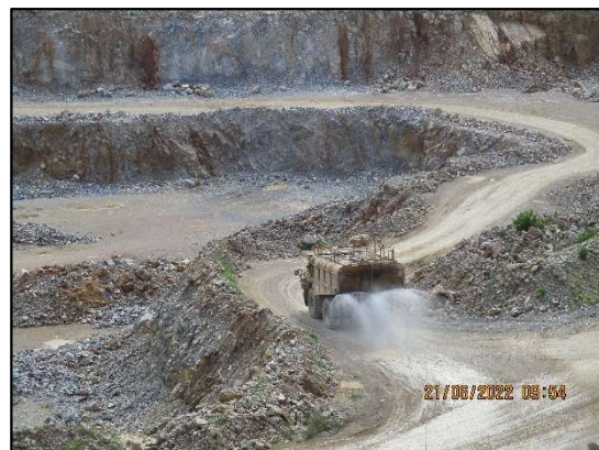
รูปที่ 2-7 รถบรรทุกน้ำฉีดพรมน้ำ เพื่อลดการฟุ้งกระจายของฝุ่นละออง
