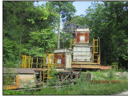
รูปที่ 2-17 ระบบสายพานติดตั้งอุปกรณ์กำจัดฝุ่น บริเวณจุดโอนถ่าย
