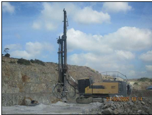
ภาพที่ 2-12 เครื่องเจาะรูระเบิดที่ติดตั้งเครื่องดักจับฝุ่นแบบถุงกรอง (Dust Collector)
